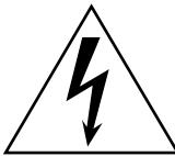
L'éclair dans le triangle est un symbole destiné à attirer l'attention de l'utilisateur sur la présence de parties non isolées et de "tension dangereuse" à l'intérieur de l'appareil, qui posent des risques d'électrocution pour l'utilisateur.
