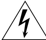
Der als Pfeil dargestellte Blitz in einem Dreieck weist den Anwender auf nicht isolierte, "gefährliche Spannungen" im Geräteinneren hin, die so stark sein können, dass sie einen Stromschlag verursachen.
